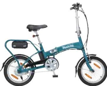
"Potencia Inteligente" en la que el motor nos aporta una fuerza proporcional a la energía con la que pedaleamos. Tipo de control por sensor de velocidad en el pedal. Funciona con 2 baterías de litio, sin efecto memoria, aumentando considerablemente los ciclos de carga así como la vida útil de la misma.
